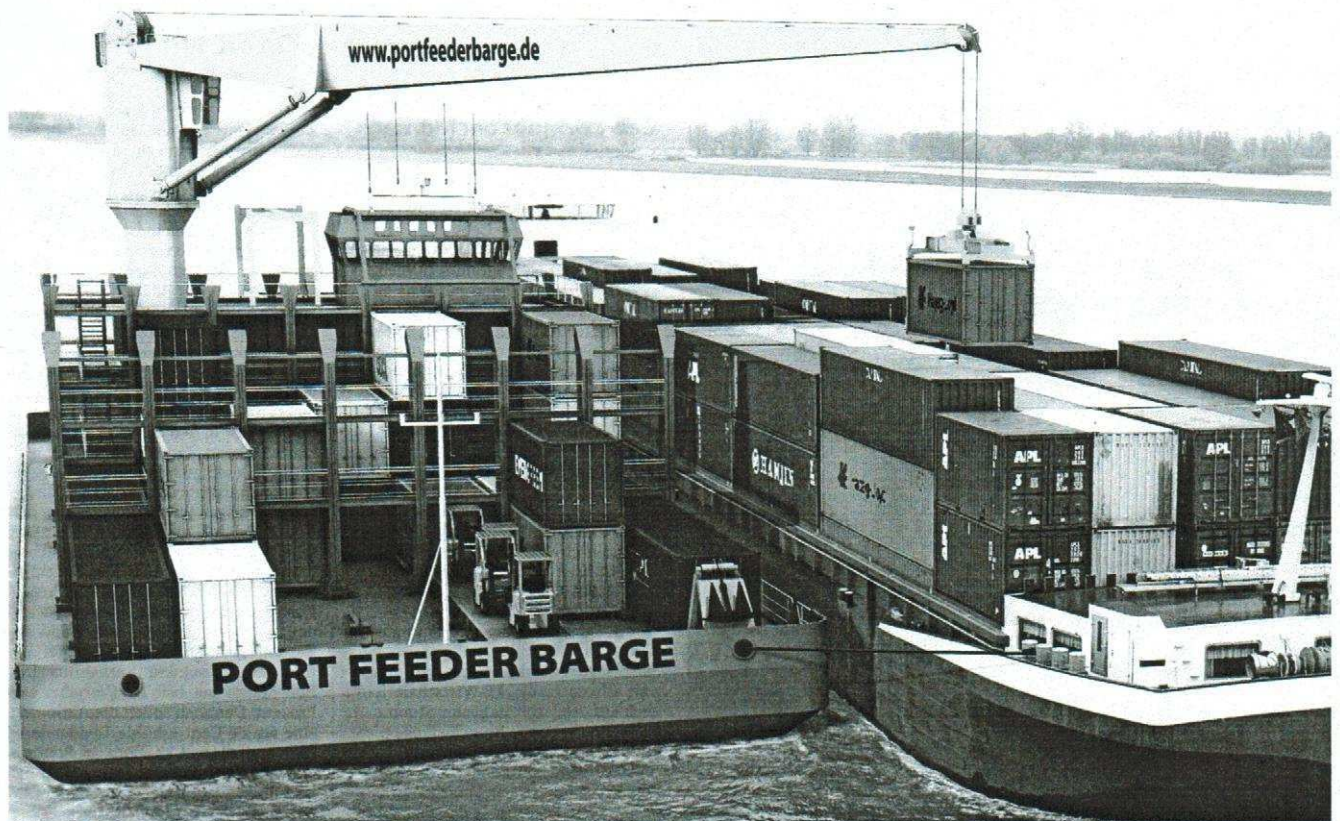
Das Konzept der Port Feeder Barge, eines selbst ladenden Container-Wassertaxis, stammt vom Hamburger Logistikexperten Ulrich Malchow
