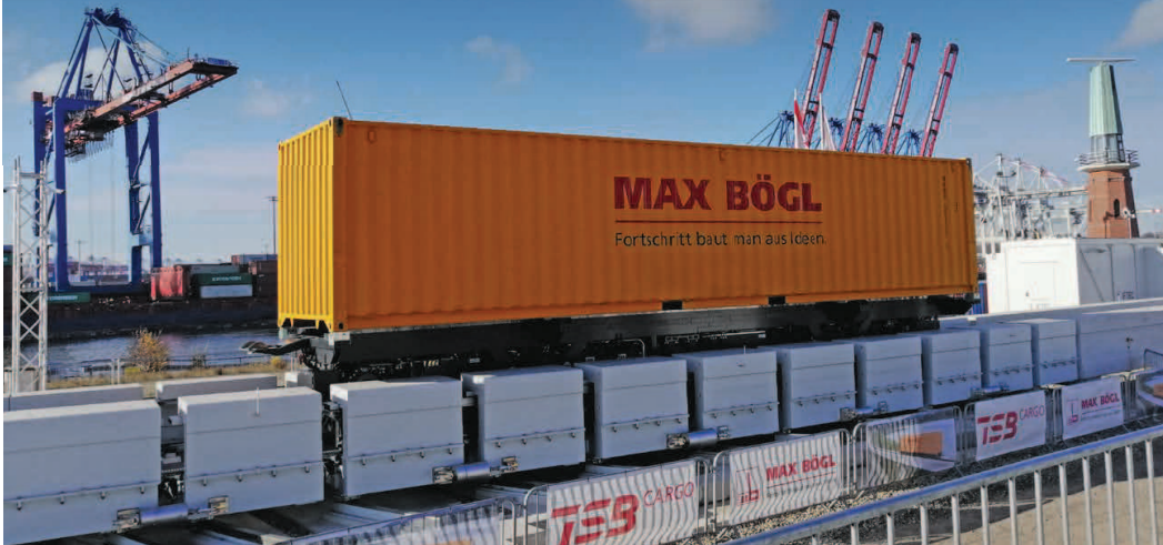
Verkehrt nur im Demonstrationsaufbau in Hamburg so niedrig, ansonsten in etwa 5 Meter Höhe: das Magnetschwebe-System TSB Cargo von Max Bögl.
